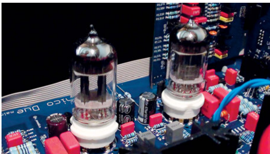
Ecco i due doppi triodi ECC83 utilizzati nello stadio di ingresso linea dell'Unico Due. Tutti gli altri stadi dell'apparecchio, incluso il pre phono, utilizzano tecnologia a stato solido.
