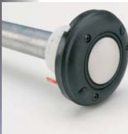
Il tweeter ha la cupola ottenuta per deposito di polvere di diamante sintetico, che possiede leggerezza, rigidità, in modo da spostare le risonanze oltre i 70.000 Hz.
