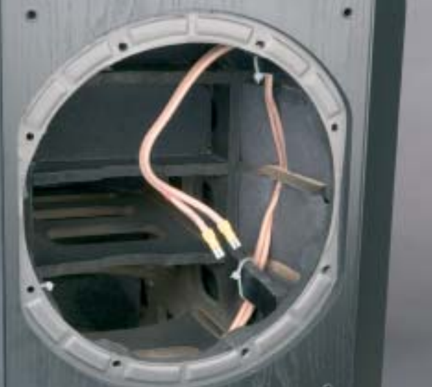
La struttura Matrix del volume dei woofer. Notare i rinforzi interni.
