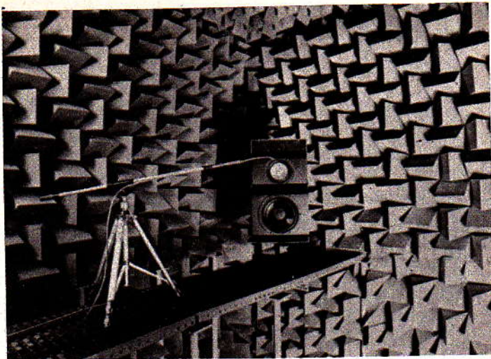
La camera anecoica della B e W usata per le misure sulle DM 6 con microfono campione davanti alla cassa.
