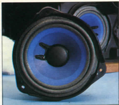
Due viste del caratteristico altoparlante a gamma estesa adottato nelle 901. Da notare il gruppo magnetico di generose dimensioni, il cestello in tecnopolimero ad alta stabilità iniettato a pressione elevata (con alloggiamento per tre sole viti) e il cono celeste che ha recentemente subito un trattamento per renderlo adeguato alle prestazioni del CD.
