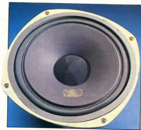
L'originale altoparlante Tannoy estratto dal mobile; da notare lo stemma in oro impresso sul cono.
