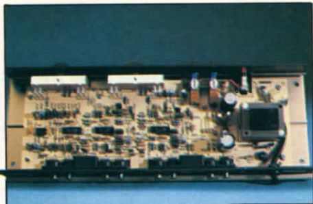
Vista dell'interno dell'equalizzatore attivo con i componenti montati su unica piastra di circuito stampato. Rispetto alle serie precedenti si nota un maggior uso di circuiti integrati.
