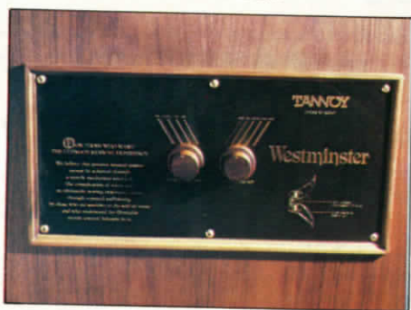
Il pannello dei controlli visto da davanti e da dietro (a lato). La targa frontale è in ottone inciso al pantografo; i componenti dell'attenuatore sono montati su basetta.
