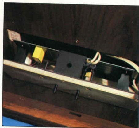
Il pannello dei controlli visto da davanti e da dietro (a lato). La targa frontale è in ottone inciso al pantografo; i componenti dell'attenuatore sono montati su basetta.
