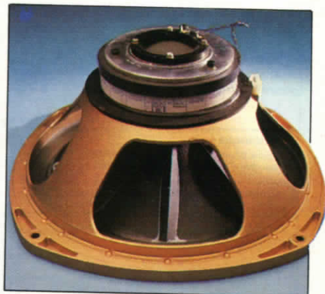
Vista posteriore dell'altoparlante con il particolare gruppo magnetico ed i rinforzi interni della membrana. Il cestello ha il caratteristico colore dorato che dà il nome all'altoparlante (gold monitor).
