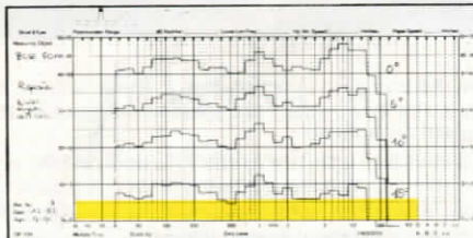
2c - In camera anecoica. Risposta in frequenza con rumore rosa filtrato a terzi d'ottava per varie angolazioni rispetto al microfono (verticale).
