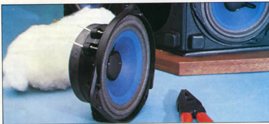
Due viste del caratteristico altoparlante a gamma estesa adottato nelle 901. Da notare il gruppo magnetico di generose dimensioni, il cestello in tecnopolimero ad alta stabilità iniettato a pressione elevata (con alloggiamento per tre sole viti) e il cono celeste che ha recentemente subito un trattamento per renderlo adeguato alle prestazioni del CD.
