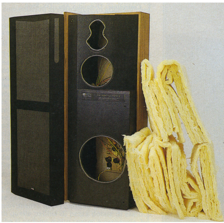
La quantità di lana di vetro inserita all'interno delle 7/07 II è particolarmente elevata il che contribuisce ad aumentare il volume equivalente del mobile.
