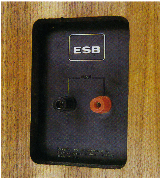
I fori dei morsetti a vite (che accettano banane, terminali a forcella e puntalini o fili non terminati) sono di diametro piuttosto ridotto e per utilizzare cavi di sezione elevata è indispensabile munirli di terminazione.
