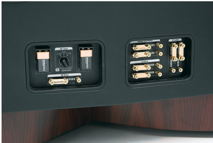
Sul frontale del diffusore, in basso, è stata posizionata una serie di deviatori a barrette dorate. Da questo pannello è possibile disinserire parte del crossover per la multi-amplificazione, controllare lo smorzamento delle basse frequenze e il livello del tweeter. È possibile anche invertire le emissioni dei due woofer.
