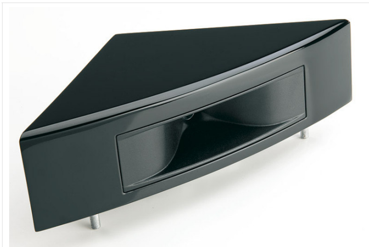
Il supertweeter è dotato di una cupola di berillio puro da 25 millimetri e di un complesso magnetico in neodimio. Notare l'alettatura della generosa camera posteriore, cui spetta il compito di assorbire l'emissione posteriore.
