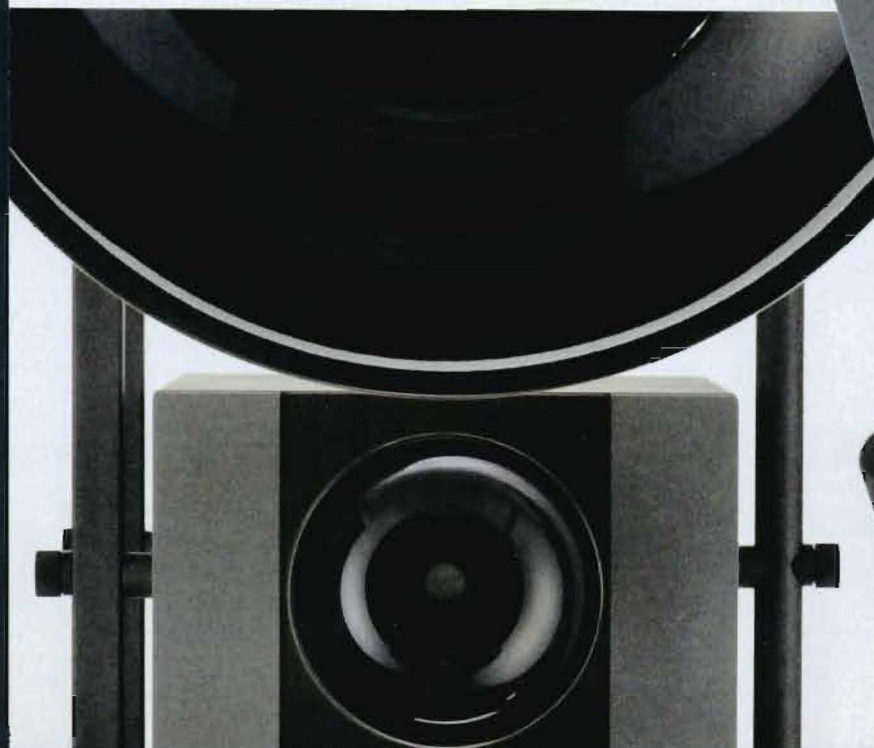
Die Trichter werden vor die eigentlichen Treiber geschraubt, das vereinfacht u.a. den Transport
