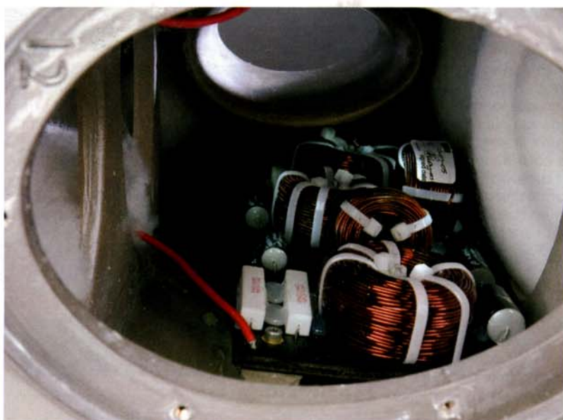
L'originale filtro crossover è ampiamente esplorato nell'apposito box. Notare la qualità della componentistica.
