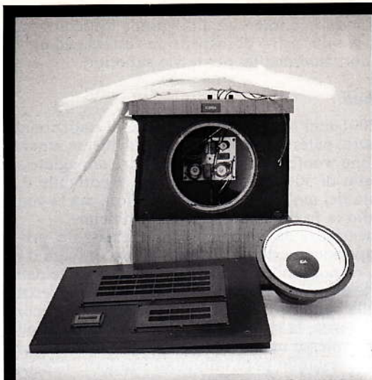
La Fostex GZ 2001 si scompone facilmente in una sezione bassi abbastanza convenzionale ed una sezione medio-alti tutta isodinamica e con irradiazione a dipolo.
