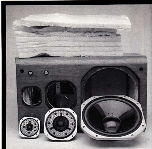
Lo stupendo e pesantissimo mobile delle NS 2000 è rinforzato al suo interno seguendo diverse ed interessanti procedure, con angolari frazionati, pannelli e tiranti in tutti i punti eventualmente critici.
