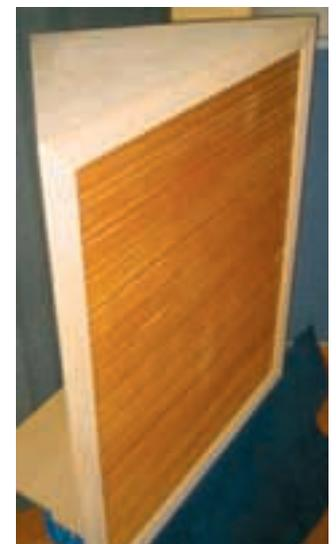
Figura 3 – Assorbitore a membrana angolare realizzato dalla SM.
