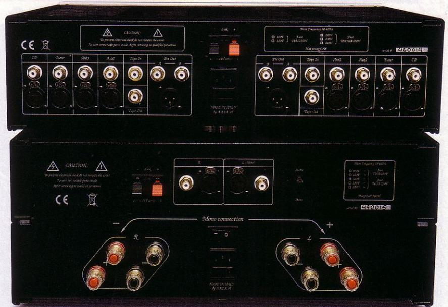
in questo caso esiste l'opzione in bilanciato ma per una sola uscita. Il panorama delle connessioni è completato da una coppia di morsetti a molla per controllare via cavo l'accensione e spegnimento del o dei finali e dalla vaschetta IEC per il cavo di alimentazione, fornito di serie.
